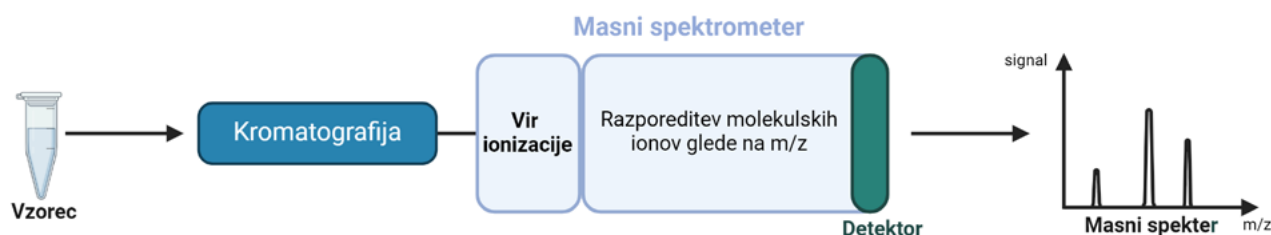
Slika 1: Shematski prikaz kromatografske metode, sklopljene z masno spektrometrijo. S pomočjo kromatografije se loči iskan analit od matriksa. Analit nato potuje v masni spektrometer, kjer najprej poteče ionizacija vzorca, s katero pridobimo nabite molekulske ione. Molekulski ioni se nato na podlagi razmerja med maso in nabojem ( m/z ) ločijo s pomočjo električnega ali magnetnega polja. Detektor zazna različne molekulske ione, kar računalnik prikaže v obliki masnega spektra. Slika je bila pripravljena s spletnim orodjem BioRender.com.
